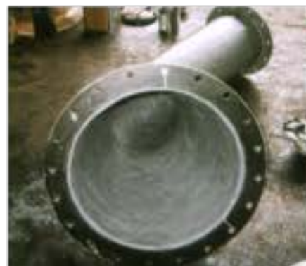
ống chuyển than đá được phủ sơn chống ăn mòn bởi
