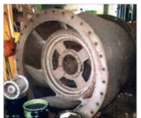
Các cạnh của cầu chì được tái tạo lại với TITANIUM PUTTY
